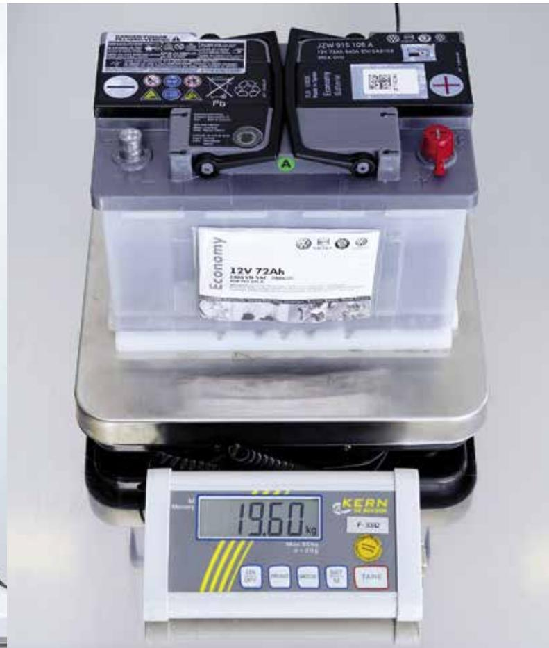
Prima del test le batterie vengono pesate per poter risalire al contenuto di piombo. La Batteria 4+ è quella con il peso maggiore.
